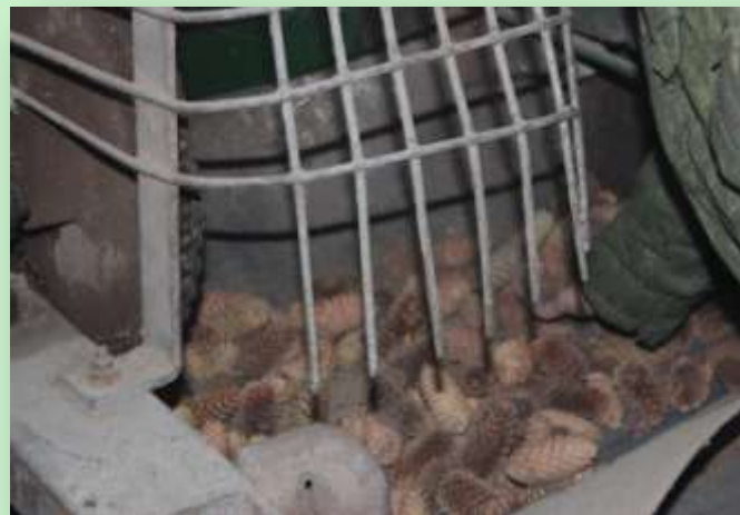
Раскрывшиеся шишки на транспортере после барабана
